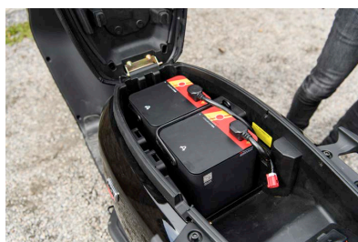
► Batterierna är seriekopplade. De måste jobba tillsammans annars blir prestandan som hos klass 2.
